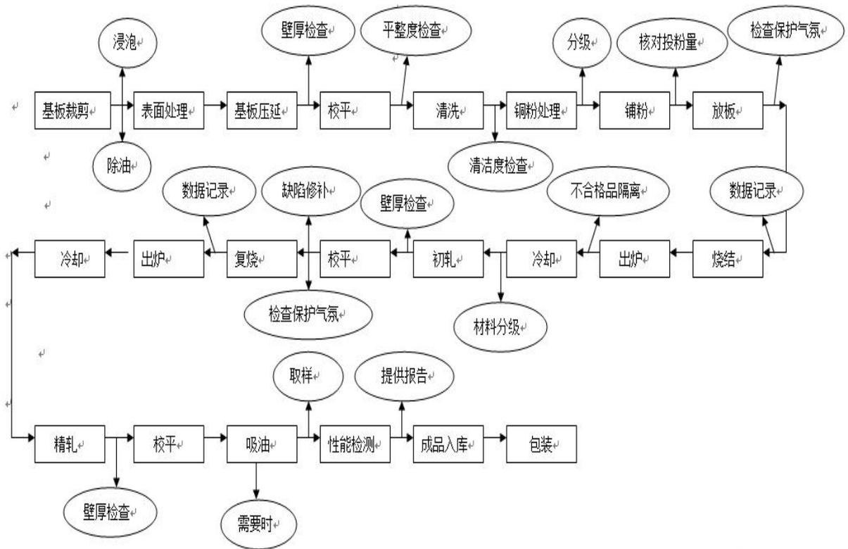
SF 无油润滑材料工艺流程图：
